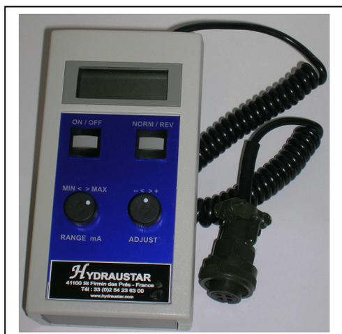
Ce testeur est destiné à la commande en boucle ouverte des servovalves (sans électronique intégrée). Il permet le contrôle de leurs fonctionnalités in-situ, ou leur pilotage dans le cadre d'interventions manuelles (dépannage, attelage de charges, etc...). Il est livré avec un connecteur MS 3106-14S-2S (autres connectiques disponibles sur demande).
